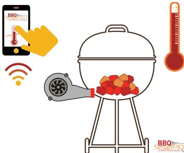
L'algoritmo PID -PWM modulerà la velocità della ventola sempre nel range 0-100% ma il valore reale della velocità di rotazione sarà scalato opportunamente in funzione del MIN/MAX fan speed.
