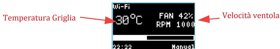
Si noti come la % della rotazione della ventola è sempre relativa al range definito da MIN fan speed – MAX fan speed nei parametri di configurazione (process parameter).
